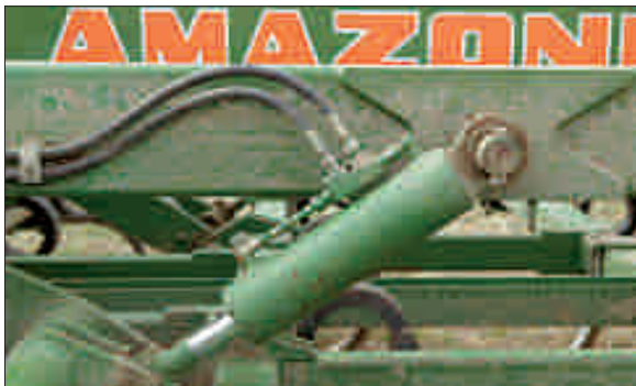
Een cilinder tussen het parallellogram met de tanden en het frame regelt de werkdiepte, die óf 10 óf 15 centimeter bedraagt.
