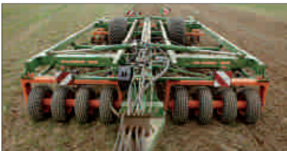
De Centaur 5.000 bestaat uit een stoppelcultivator met vier rijen tanden, een schijveneg en een packerwals.
