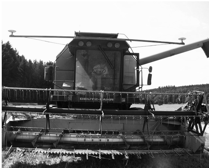
Abb. 10-4: Anbringung der GPS-Antennen auf dem Mähdrescher
